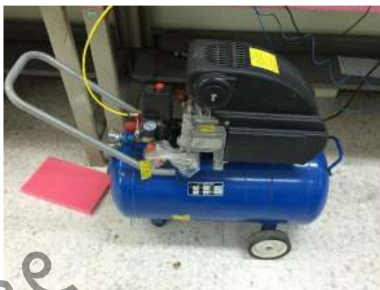
ภาพที่ 3.8 ถังลมแหล่งจ่าย
