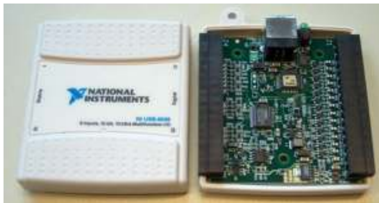
ภาพที่ 3.13 อุปกรณ์ฮาร์ดแวร์ NI DAQ รุ่น USB-6008
